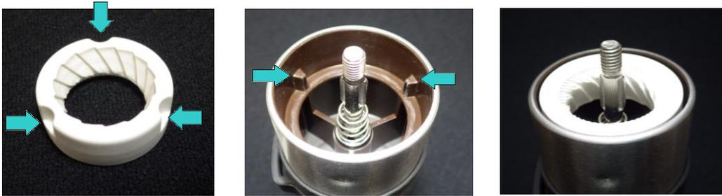
・外刃の外周にある外刃回り止め(3カ所の溝)を本体内部の本体回り止め(3カ所の突起)に合わせて入れます。
